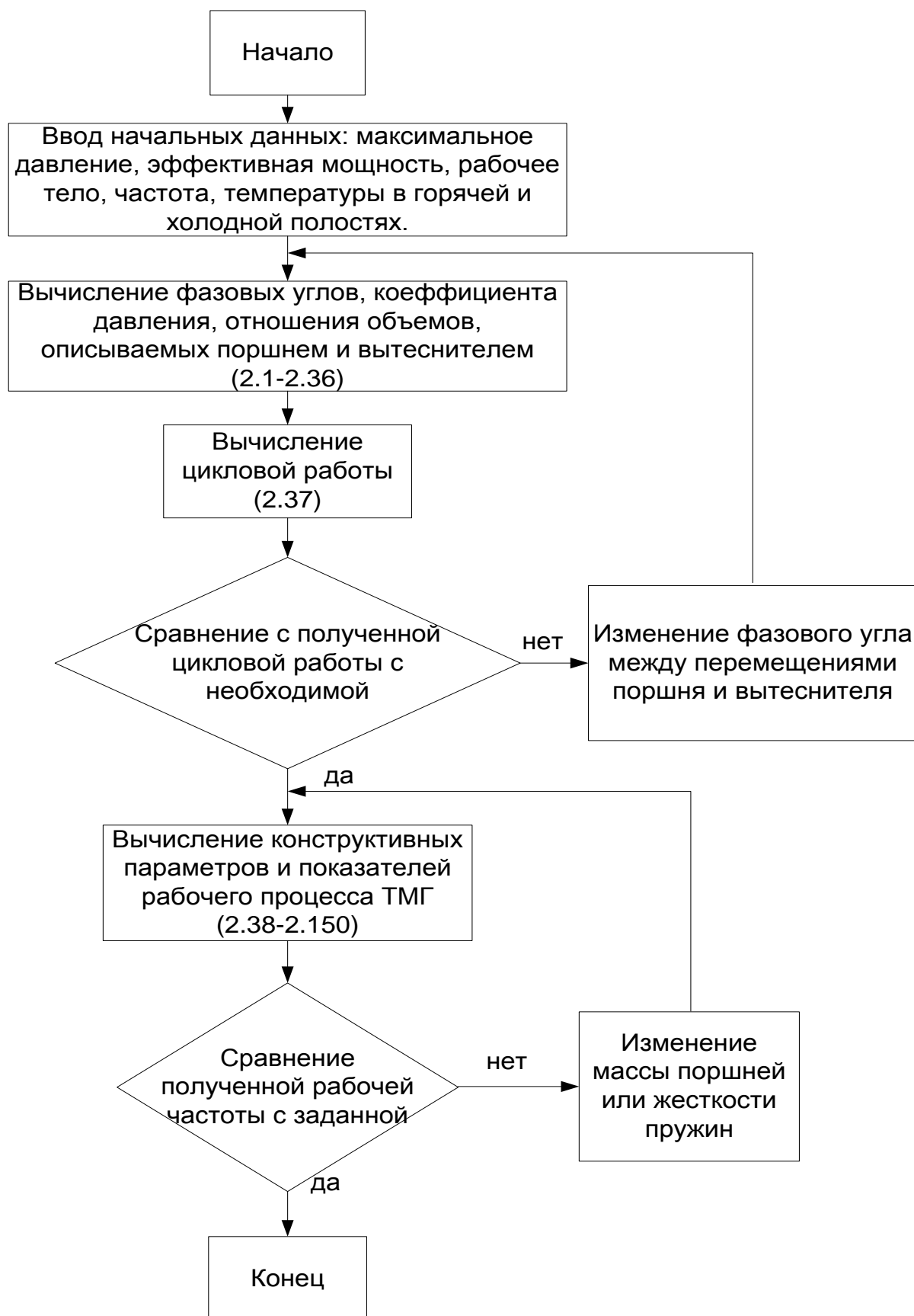
Рис. 3. Алгоритм проведения конструкторского расчета ТМГ
