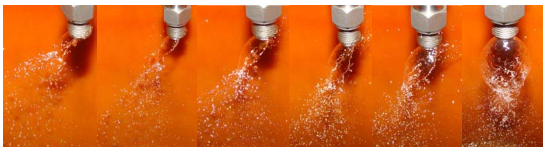
Рис. 8. Развитие топливной струи клапанной форсунки
