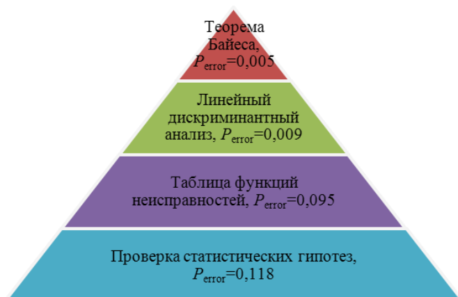
Рис. 14. Диаграмма сравнения алгоритмов диагностирования подклассов \omega_{13} и \omega_{21} , (режим стартерной прокрутки)
