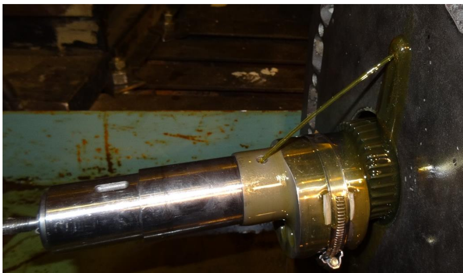
Рис. 10. Вид масляной струи, подающейся для охлаждения ротора.
