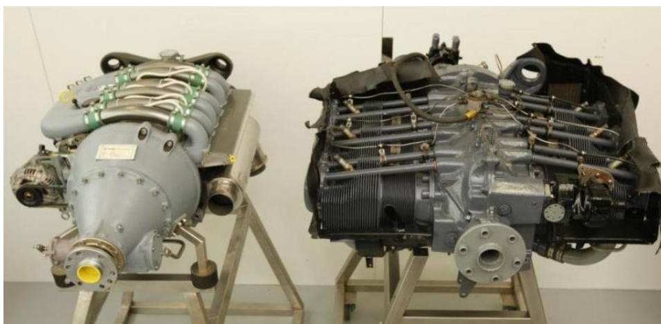
Рис. 2. Сравнение авиационных РПД Mistral G300 (300 л.с.) и ПД Lycoming (260 л.с.)
