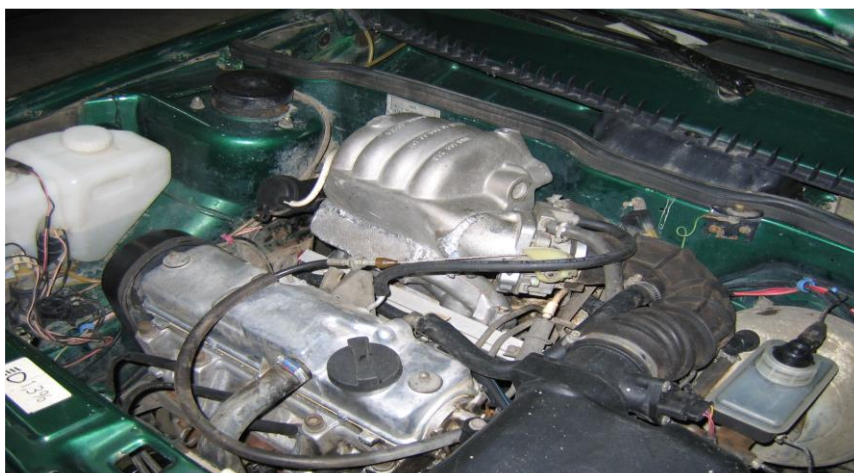
Рис. 3. Двигатель ВАЗ-2111 с модернизированной системой впуска
