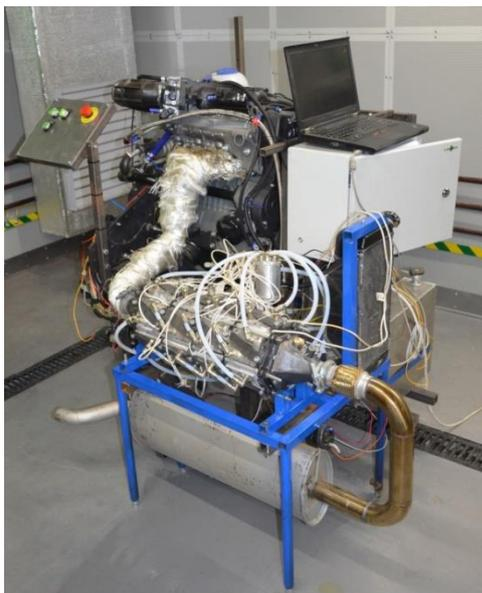
Рисунок 6 – ТЭГ, установленный на испытательный стенд.
