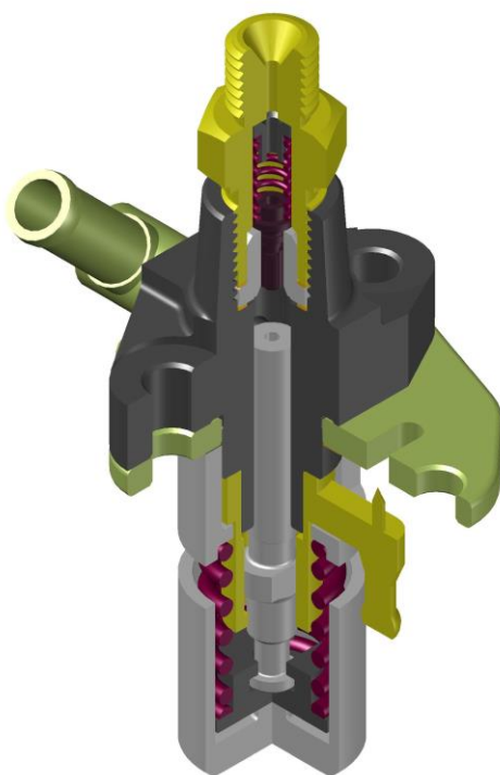
Рис. 1. Общий вид ТНВД типа YPFE-M.
