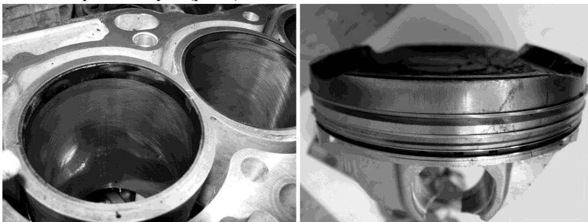
Рис.3. Главный признак гидроудара - расширение пояса нагара в верхней части цилиндра (слева), и один из подтверждающих признаков - стертый нагар над отверстием поршневого пальца (справа), свидетельствующий о деформации шатуна и работе поршня
