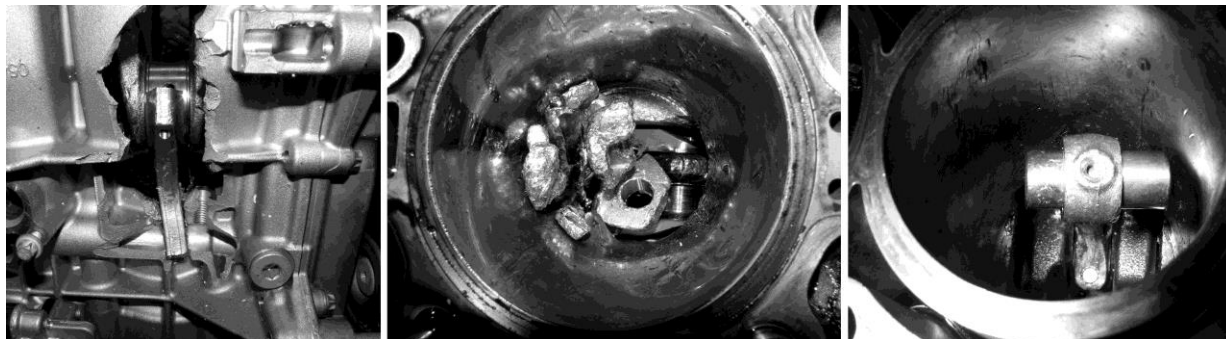
Рис.1. Последствия тяжелых повреждений ДВС при гидроударе (слева), масляном голодании (в центре) и обрыве клапана (справа).
