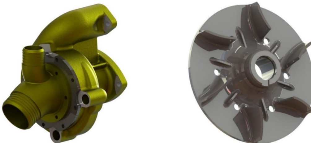
Рисунок 2 – Твёрдые модели корпуса с подводными патрубками и рабочего колеса насоса
