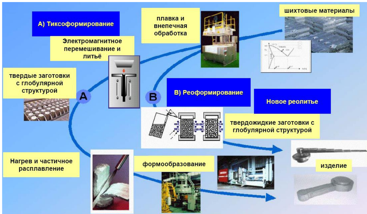
Рис. 6. Две схемы тиксоформинга при производстве фасонного изделия из твердожидкого металла
