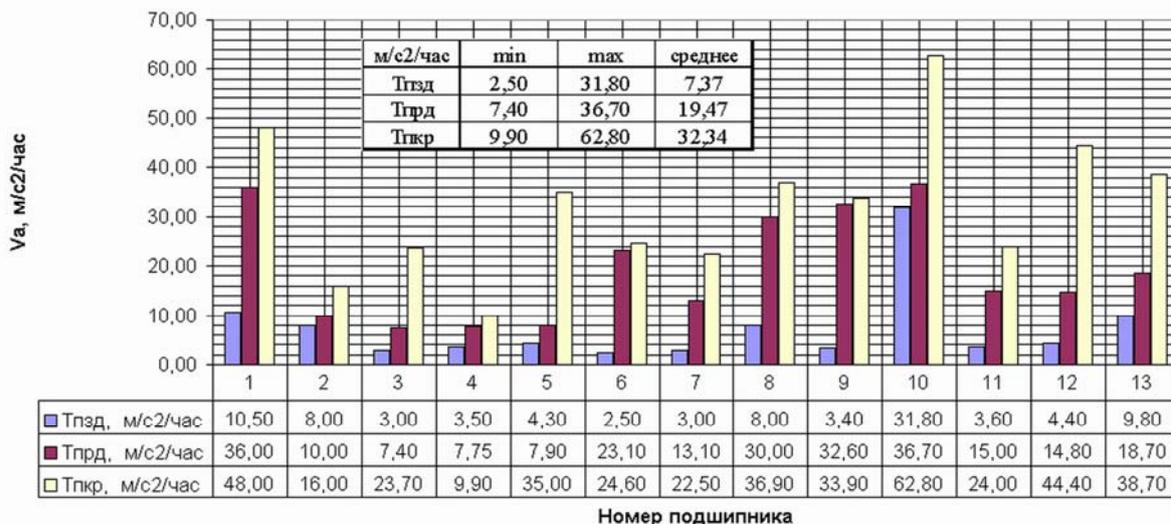
Рисунок 3. Распределение скорости изменения виброускорения по периодам разрушения подшипника
