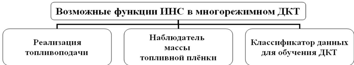
Рис. 1. Возможные функции ИНС в составе многорежимного ДКТ.
