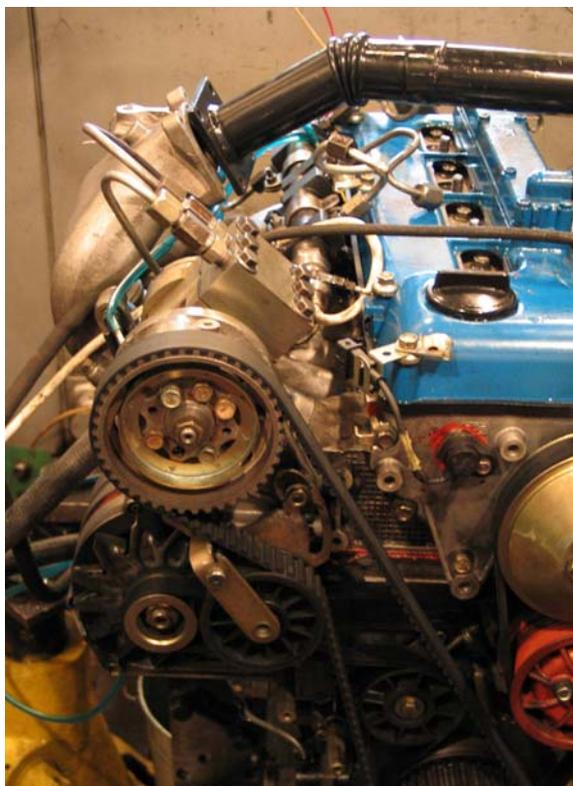
Испытания разработанного ТНВД не ограничились безмоторными испытаниями. Разработанная в ОАО НИКТИД (г. Владимир) оригинальная отечественная система CR в своем составе содержит все отечественные компоненты: блок управления, электрогидравлические форсунки, клапаны управления, а также описанный ТНВД (рис. 3). Система установлена и дорабатывается на дизеле ЗМЗ 514. Несмотря на необходимость совершенствования, система является работоспособной и обеспечила работу дизеля на моторном стенде ОАО НИКТИД.
