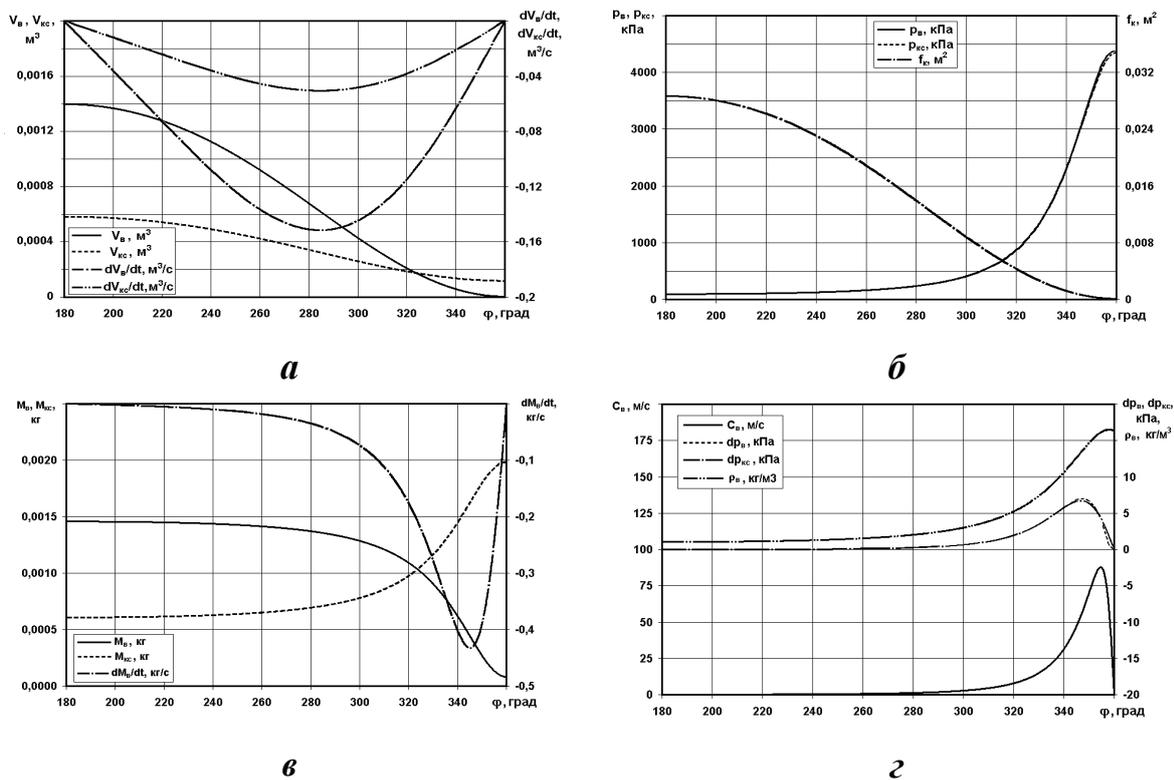
Рис. 2. Изменение параметров движения воздуха в КС типа АМЗ по углу поворота кривошипа  $\varphi$ : *а* - объемов полостей «В» и «КС»; *б* - давления в этих в полостях  $p_B$  и  $p_{КС}$  и площади сечения между ними  $f_K$ ; *в* - массы газа в полостях  $M_B$  и  $M_{КС}$  и скорость изменения массы в полости «В»  $dM_B/dt$ ; *г* - плотности газа в полости «В»  $\rho_B$  и скорости перетекания газа  $C_B$  из полости «В» в полость «КС».
