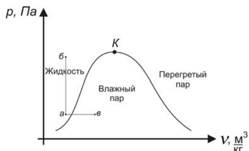
Рис.3. Идеальный процесс изменения параметров топлива в стандартной системе распределенного впрыска: а-б – процесс повышения давления топлива насосом 3 (рис.1), б-а – процесс падения давления топлива при его распылении через форсунку
