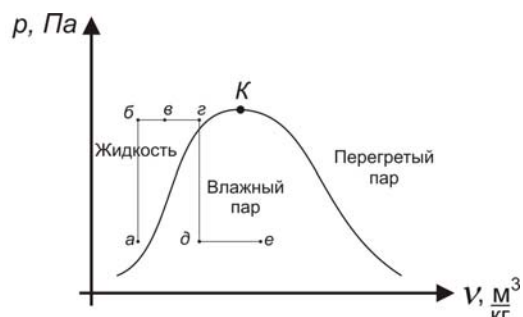
Рис.4. Идеальный процесс изменения параметров топлива в системе распределенного впрыска перегретого топлива: а-б – процесс повышения давления топлива насосом 3 (рис.2), б-в – процесс подвода теплоты к топливу в регенераторе 5 от отработавших газов и/или охлаждающей жидкости и/или смазочного масла; в-г – процесс подвода теплоты к топливу от электрического нагревателя 7, г-д – процесс падения давления топлива при его распылении через форсунку 8, д-е - процесс подвода теплоты от тарелки впускного клапана работающего двигателя к топливу.
