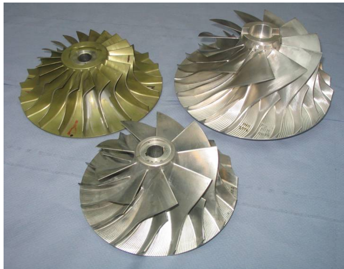
Рис. 1. Рабочие колеса турбокомпрессоров (слева: секционированное колесо с радиальным выходом, колесо с загнутыми назад лопатками, компрессор для высоких степеней сжатия)
