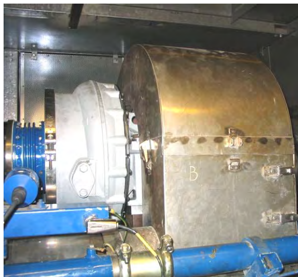
Рис. 7. Турбокомпрессор TCR 16 в газовом двигателе ( P = 1050 кВт n = 1500 мин -1 , топливо – природный газ)
