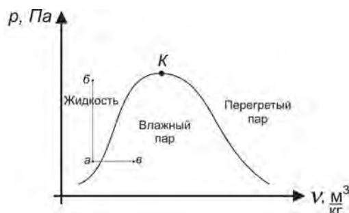
Рис.3. Идеальный процесс изменения параметров топлива в стандартной системе распределенного впрыска: а-б – процесс повышения давления топлива насосом 3 (рис.1), б-а – процесс падения давления топлива при его распылении через форсунку 6, а-в - процесс подвода теплоты от тарелки впускного клапана работающего двигателя к топливу
