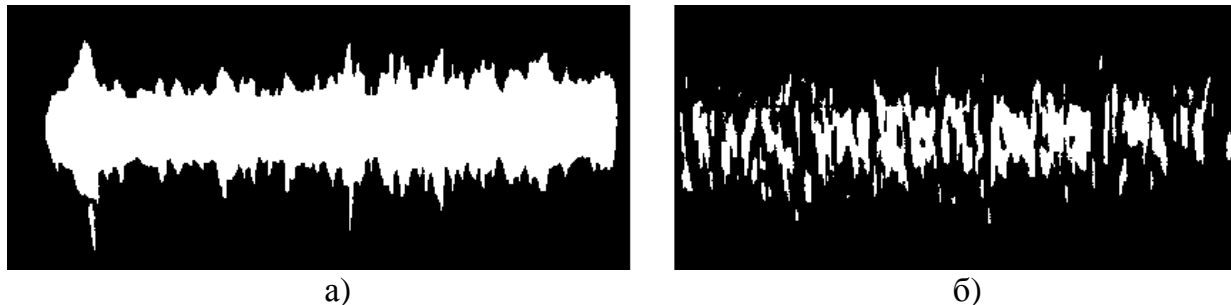
Рис.6. Осциллограмма, начала, развития (а) и самого процесса (б) заедания
