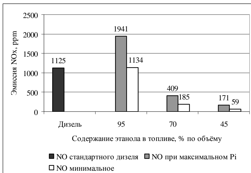
Рис. 3. Зависимость изменения эмиссии оксидов азота от вида топлива; режим частичной нагрузки
