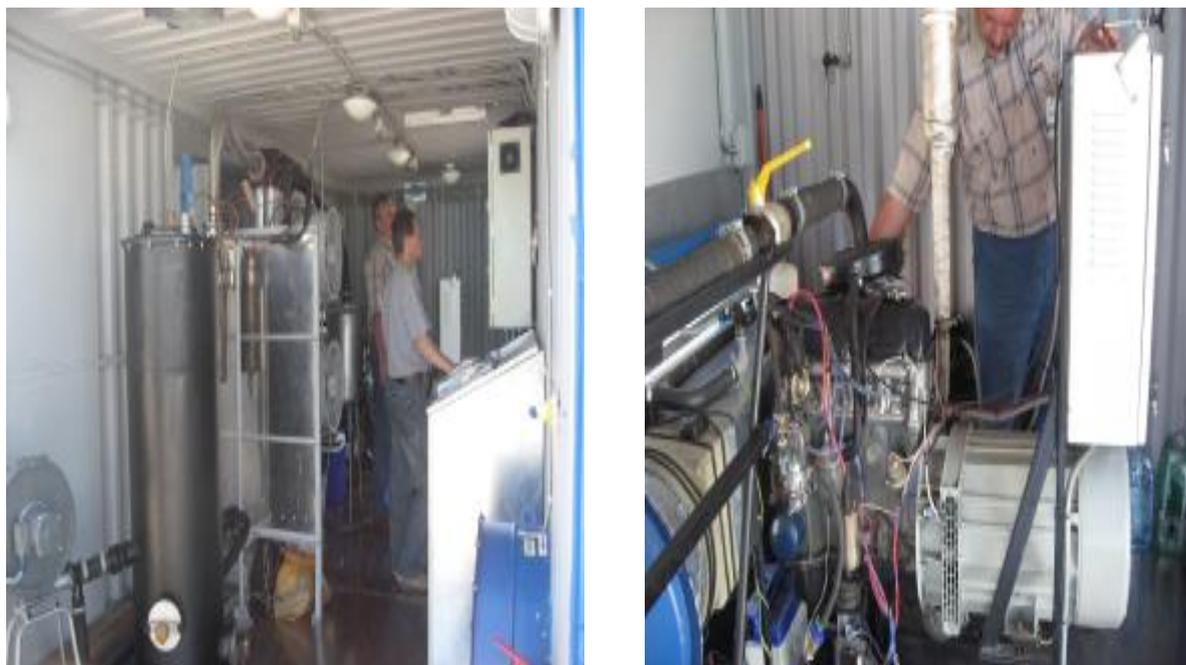
Рис. 1. Энергоустановка с двигателем ВАЗ-2106 (Форум «Технологии в машиностроении» 2010г.)
