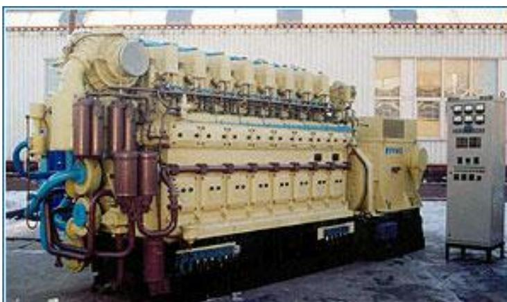
Рис. 1. Комбинированный поршневой дизельный двигатель 8ЧН 22/28
