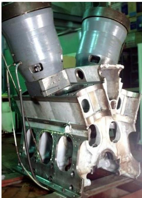
Рис. 2. Стенд для усталостных испытаний блока цилиндров.
