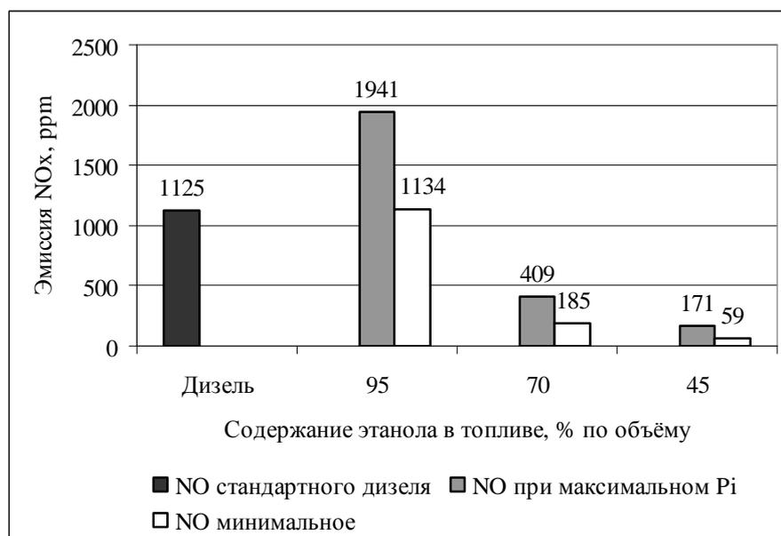
Рис. 3. Зависимость изменения эмиссии оксидов азота от вида топлива; режим частичной нагрузки
