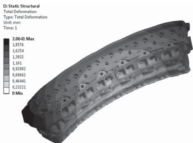
Рисунок 1 – Перемещения моноблока от температуры и монтажных нагрузок
