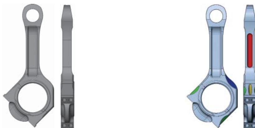
а) б) Рисунок 1 – Оптимизируемая модель шатуна: а – базовая модель; б – оптимизированная модель.
