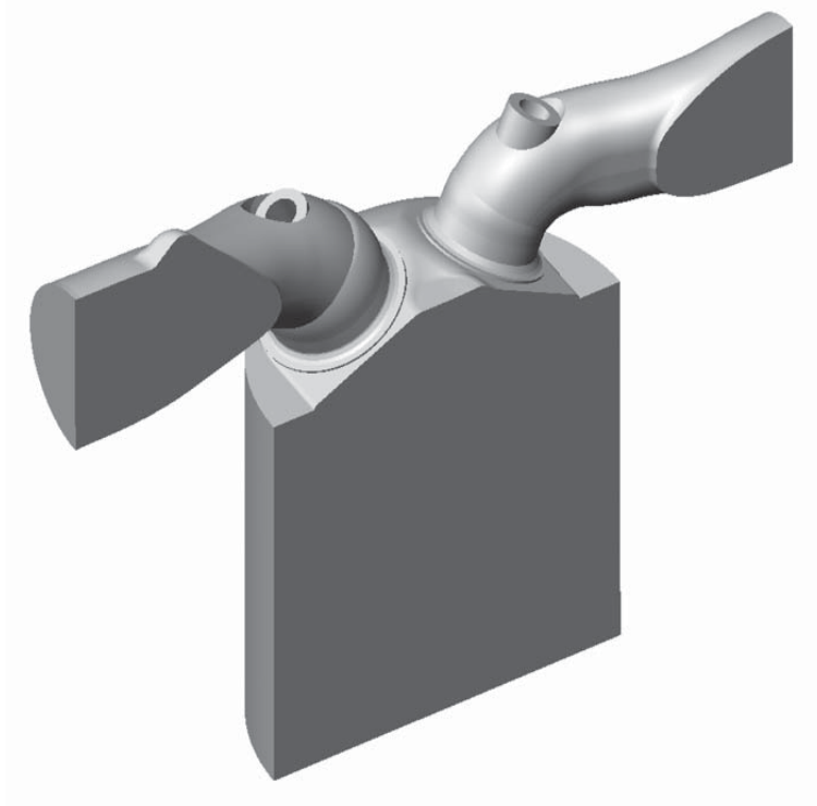
Рисунок 1 – Геометрия каналов и камеры сгорания
