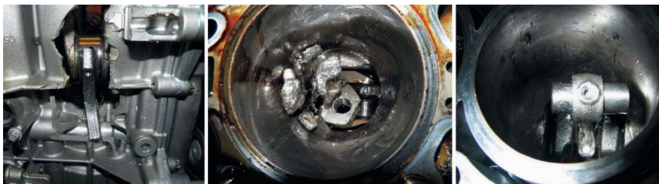
Рис. 1 – Наиболее распространенные виды тяжелых повреждений ДВС в эксплуатации: 1) – разрушение шатуна блока цилиндров после деформации, 2) – разрушение поршня и шатуна в результате нарушения подачи масла к подшипнику, 3) – разрушение поршня после обрыва головки клапана.
