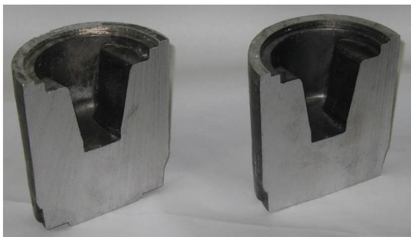
Рис. 4. Разрезы опытных образцов заготовок поршня КАМАЗ 7405 из сплавов АК12М2МгН (слева) и АК4 (справа)
