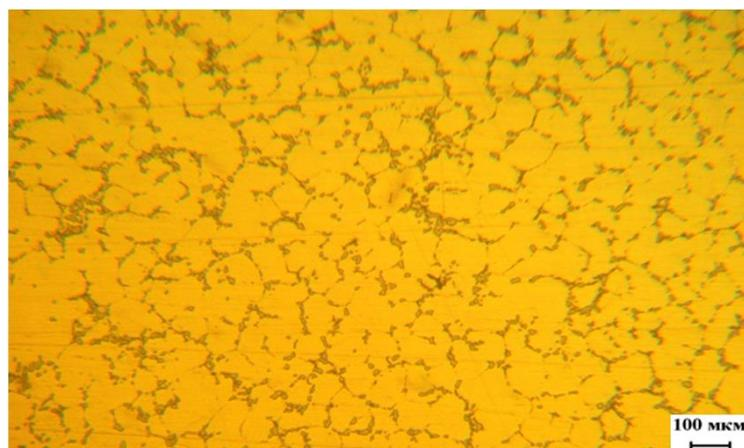
Рис. 3. Микроструктура заготовки из сплава АК12М2МгН
