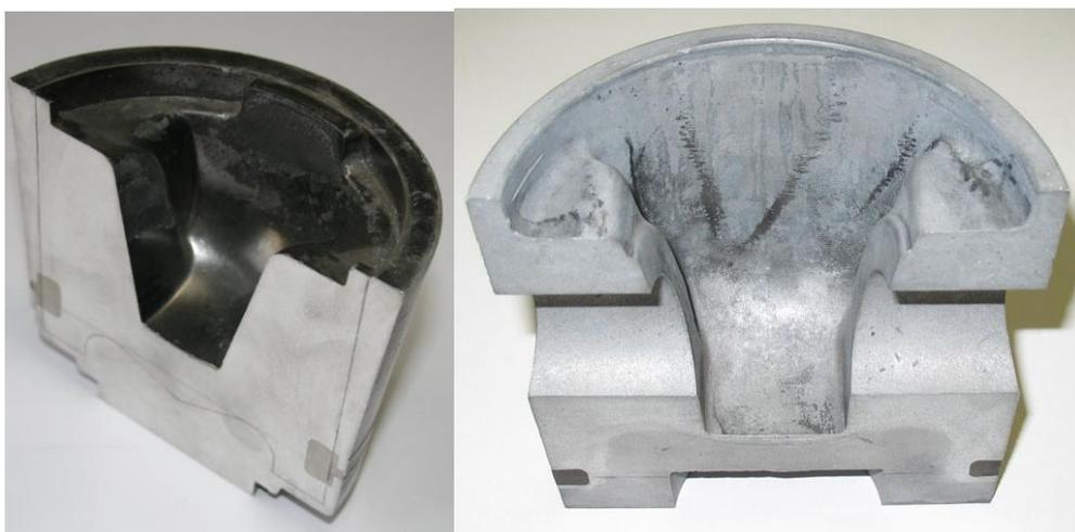
Рис. 1. Заготовки поршней для дизельного двигателя из сплава АК12М2МгН с применимее керамической вставки и нирезистового кольца
